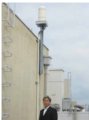
▶大津市の衛生科学センターで稼働中のモニタリングポスト
